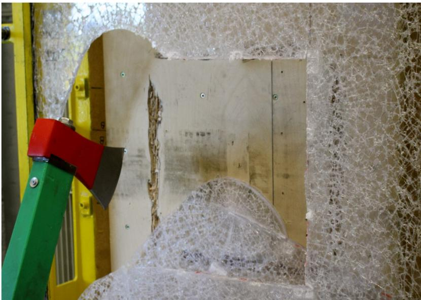
**Bild 13** Ausbrechen der Polycarbonat-Verbundtafel bei der Prüfung mit der Axt.
