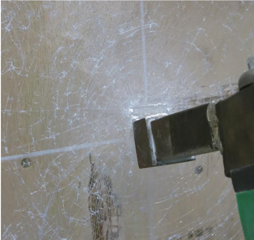
**Bild 14** Lockerungsschlag an der ersten Auftreffstelle zur Zerstörung aller Glastafeln in der Verbundtafel. Erst nach mehrmaligen Auftreffen sind die vordere und hintere Glastafel zerstört.
