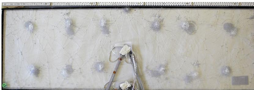
**Bild 37** Planmäßig zerstörte Dünnglas-Polycarbonat-Verbundtafel mit dem Dünnglas Leoflex zur Untersuchung des Resttragverhaltens.
