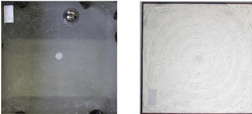
**Bild 11** Darstellung des Bruchbildes an der Oberseite der Verbundtafel im Kugelfallversuch.
