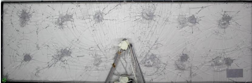
**Bild 35** Planmäßig zerstörte Dünnglas-Polycarbonat-Verbundtafel mit dem Dünnglas Optiwhite zur Untersuchung des Resttragverhaltens.
