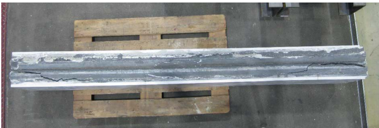
Abbildung 2-17: Dreischaliges Wandelementteil nach Versuch.
