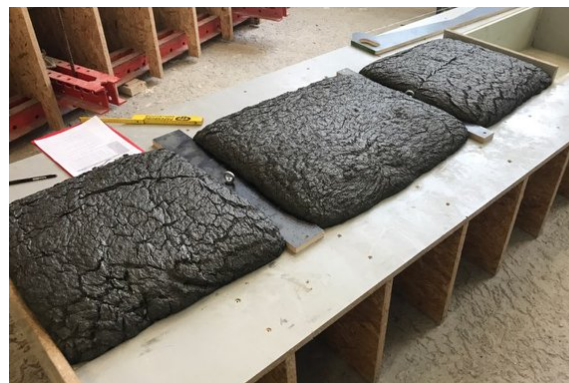
Abbildung 1-11: Aufgeschäumter CLMS im Werksversuch bei Fa. Hentschke Bau
