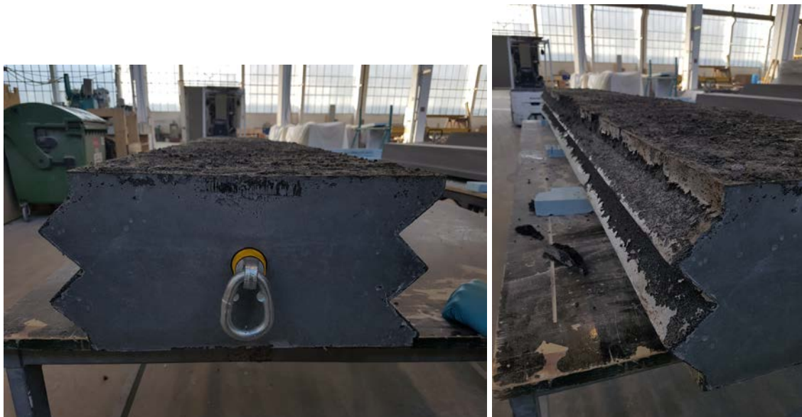
Abbildung 3-3: Schaumkern nach dem Ausschalen.
