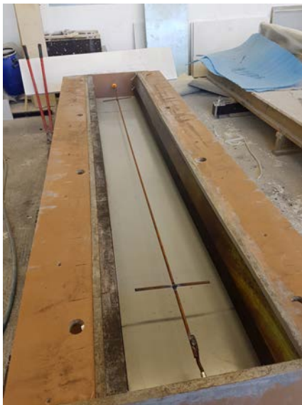
Abbildung: 3-1: Schalung für einen Schaumkern mit Transportankern (links), und eingefüllter Schaumbeton beim Auftreiben (rechts).
