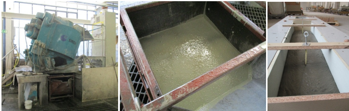
Abbildung 1-10: Werksversuch Oktober 2015. Eirich-Intensivmischer R11 (links), verfrühtes Auftreiben des CLM-Schaums in der Transportschütte sichtbar durch Erhöhte Blasenbildung an der Betonoberfläche (mittig) und dem entsprechend geringen Auftreiben (rechts).
