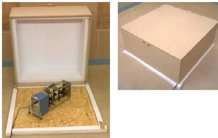
**Abb. 18:** Schallabsorbierende Abdeckhaube zur Verminderung der Luftschallabstrahlung des Norm-Hammerwerks. Im linken Bild ist die Haube in geöffnetem Zustand zu sehen, im rechten Bild ist sie geschlossen.
