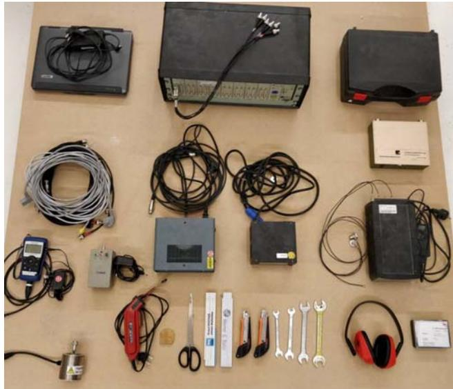
**Abb. 42:** Übersicht über die wichtigsten Komponenten der verwendeten akustischen Messausrüstung.
