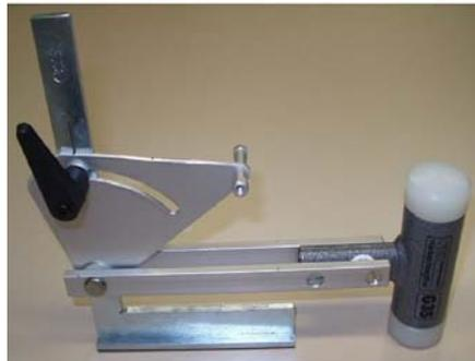
**Abb. 22:** Empa-Pendelfallhammer nach SIA 181 zur Nachbildung von Benutzungsgerauschen im Sanitärbereich.
