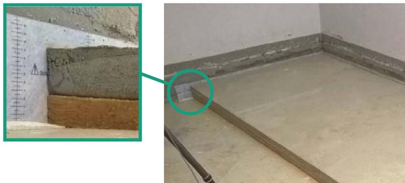
**Abb. 26:** Teilflächiger schwimmender Estrich (Ausschnitt) auf der Massivdecke im Prüfstand P9. Der dargestellte Aufbau bestand aus einer 60 mm dicken Bodenplatte aus Zementestrich, die auf einer 40 mm dicken Trittschalldämmplatte aus Glaswolle (Isover Akustic EP 1) gelagert war.
