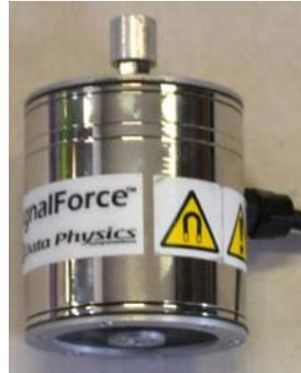
**Abb. 16:** Darstellung des bei den Messungen verwendeten Inertial-Shakers vom Typ Data Physics IV40/PA30E. Die vom Shaker erzeugte Kraft beträgt maximal 30 N (Effektivwert), die Inertialmasse liegt bei 1,21 kg und die Eigenresonanz erfolgt bei 30 Hz.
