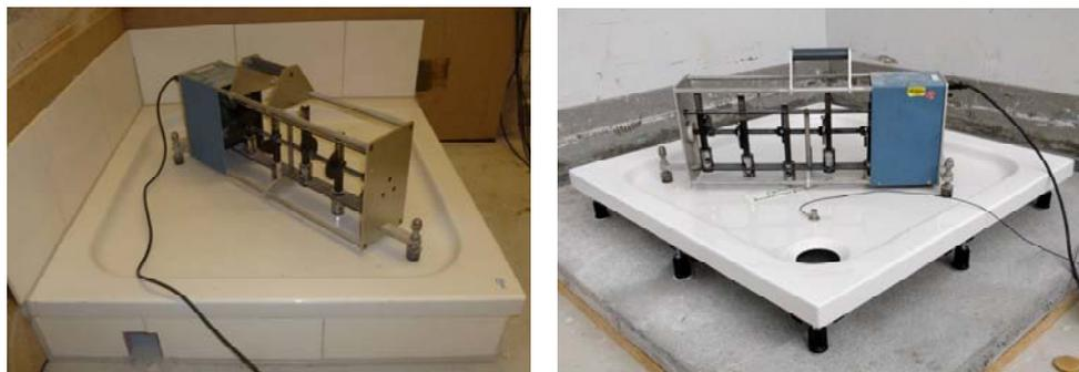
**Abb. 40:** Duschwanne DW1 a. FG bei praxisgerechtem Einbau mit Untermauerung, Verfliesung und elastischer Abdichtung der Fugen (links) und bei vereinfachter Montage (rechts). Bei der vereinfachten Montage wurde die Wanne mit dem Fußgestell nur lose auf der Decke aufgestellt.
