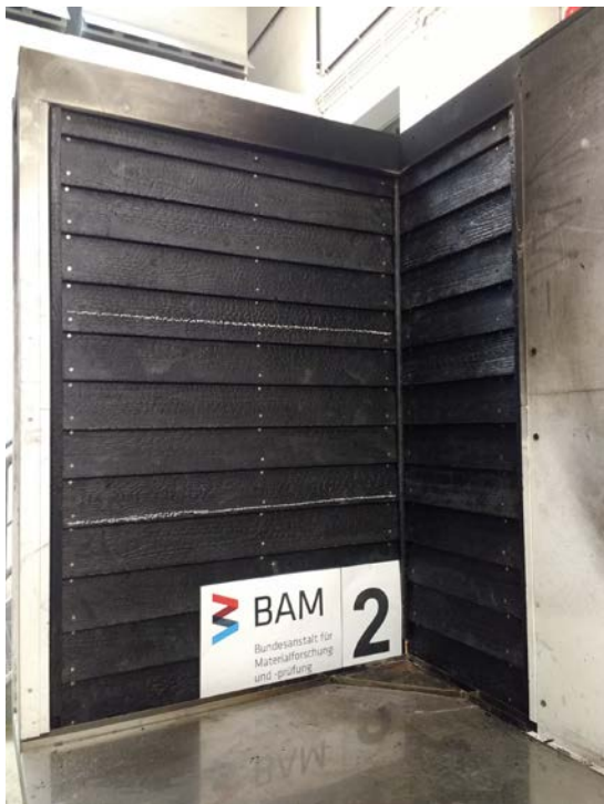
Abbildung 59 und 60 Probekörper für SBI-Test 2 vor und nach dem Test. Abbildung 60 zeigt deutlich das Nachbrennen der Konstruktion nach Abbruch des Tests.
