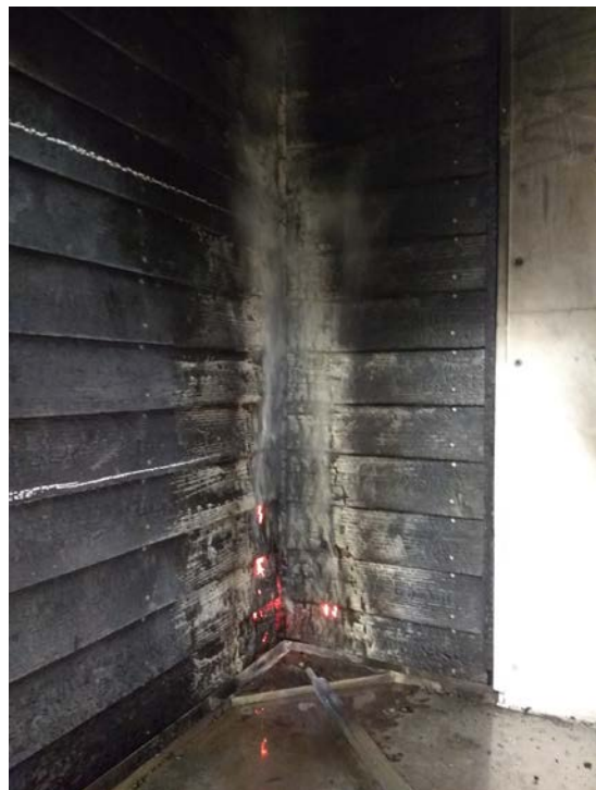
Abbildung 59 und 60 Probekörper für SBI-Test 2 vor und nach dem Test. Abbildung 60 zeigt deutlich das Nachbrennen der Konstruktion nach Abbruch des Tests.
