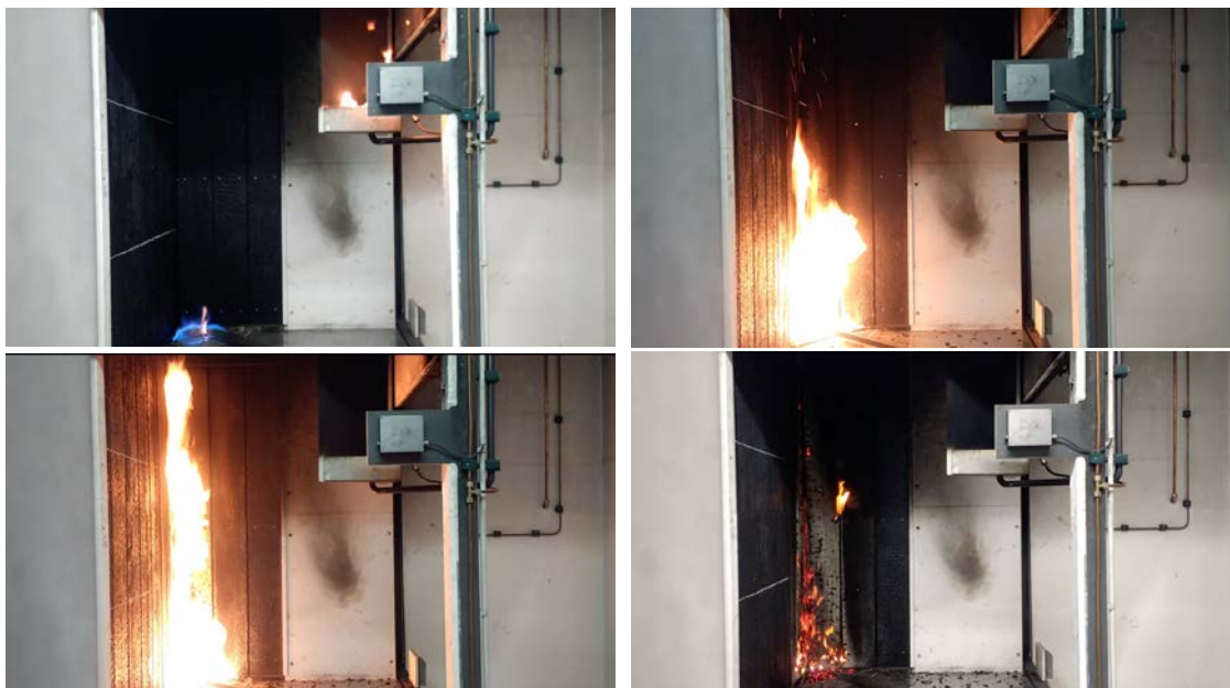
Abbildung 52 bis 55 SBI-Test 1: Testverlauf: Minute 0 (Start), Minute 7, Minute 14, Minute 21 (Ende)
