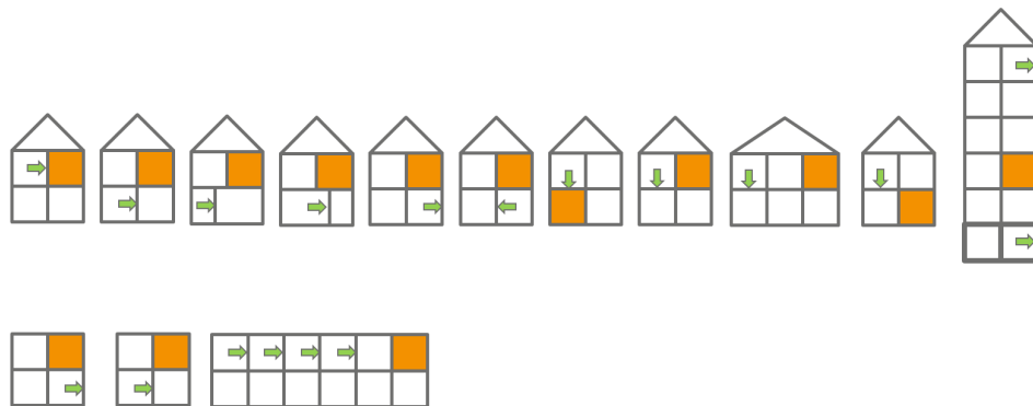
Abbildung 6 Beispiele für Übertragungspfade. Dabei stellt der grüne Pfeil die Anregung dar und der orange markierte Raum den Empfangsraum (ER). Die Skizzen stellen schematisch Gebäudeschnitte dar (obere Reihe Vertikalschnitte, untere Reihe Horizontalschnitte)
