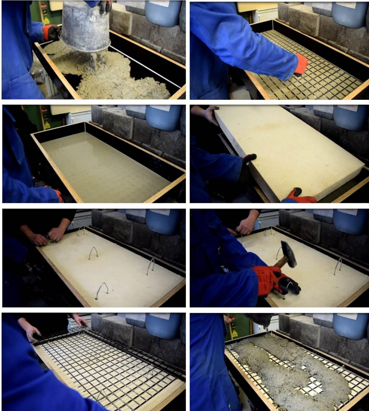
Abbildung 19 Herstellungssequenz eines Sandwiches durch Eindrücken in Frischbeton und anschließendem Aufgießen der oberen Deckschicht in passgenauer Form (Variante 3, Quelle: Universalbeton Heringen)
