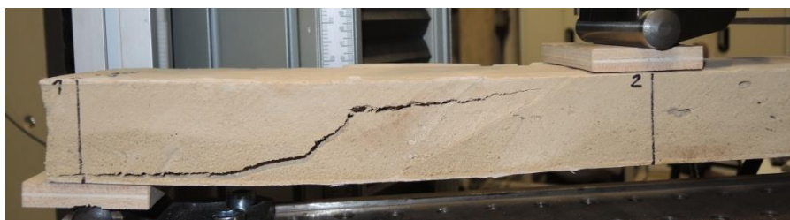
Abbildung 34 Frühes Versagen mit Ausriss am linken Balkenrand
