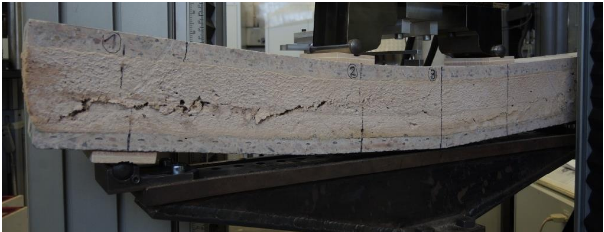
Abbildung 38 Überblick des Versagens an hohem Sandwichbalken mit Betondeckschichten von ca. 20 mm Stärke (UBH2), Erstrisse in der Zugzone der unteren Deckschicht initiieren das anschließende Schubversagen im querkraftbeanspruchten Holzschaukern
