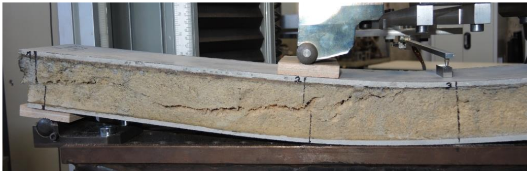
Abbildung 31 Biegeprüfung PVAC-geklebter Betondeckschichten auf 50 mm dickem Kiefernholzschaum (Dichte 70 \text{ kg/m}^3 )
