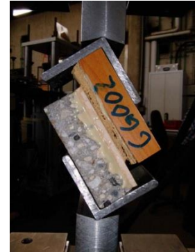
Abbildung 22 Druck-Schub-Probe zwischen Lasteinleitungsprismen für Ermittlung der Haftung zwischen Deckschicht und Holzschaum, Prinzip (links), Experiment (rechts)
