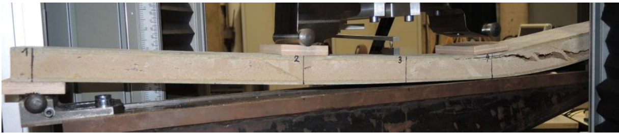
Abbildung 30 Zerstörende Biegeprüfung an 2K-PUR-geklebten Betondeckschichten auf 25 mm dünnem Buchenholzschäum mit relativ hoher Dichte von 123 \text{ kg/m}^3
