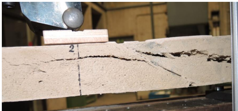
Abbildung 28 Riss durchwandert Grenzschichten (geschäftete Klebung unter 25° für lange Kern-Streifen aus kürzeren Einzelstücken) in einem 45 mm dicken Holzschaumkern
