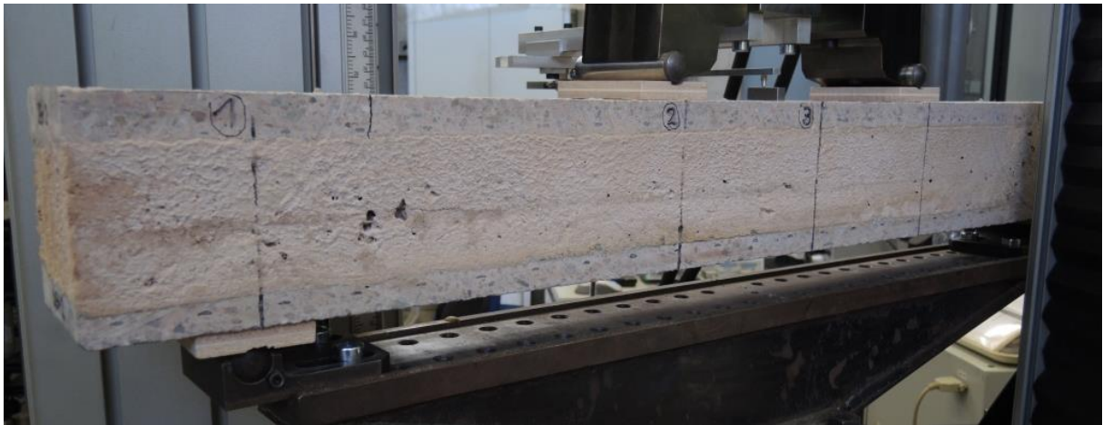
Abbildung 37 Biegung von hohem Sandwichbalken mit Betondeckschichten von ca. 20 mm Stärke (UBH2)
