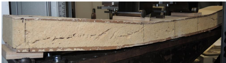
Abbildung 33 Biegeprüfung aufgegossener Aluminat-Betondeckschichten auf 50 mm dickem Kiefernholzschaum (Dichte 70 \text{ kg/m}^3 )
