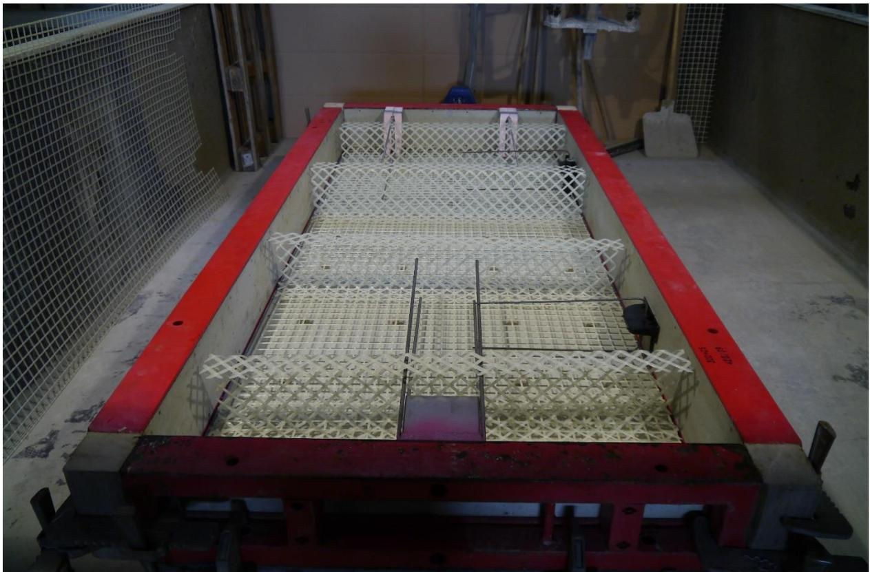
Abbildung 94: Schalung mit eingelegter Bewehrung und Einbauteilen vor dem Betonieren
