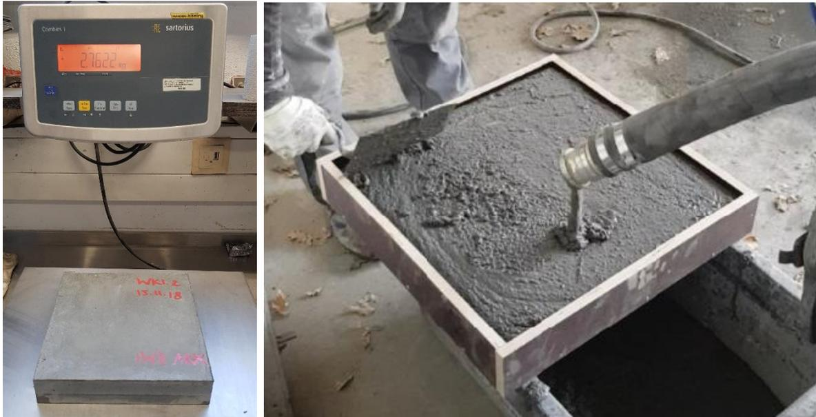
Abbildung 73: Skalierte Wandelemente (links: 1:6,6 skaliertes Element beim Wiegen, rechts 1:2 skaliertes Element in der Herstellung)
