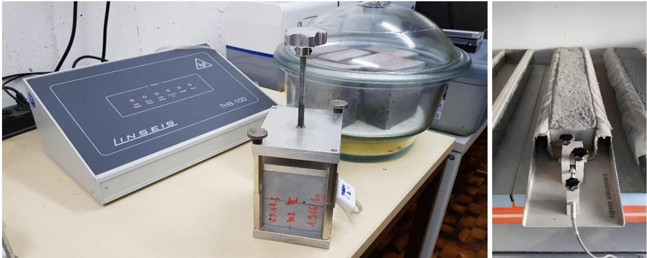
Abbildung 71: THB-Gerät und Leichtbetonprüfkörper während des Messvorganges (links) und Schwundrinne mit Leichtbetonprobekörper (rechts)
