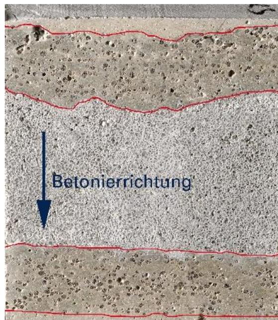
Abbildung 67: Struktur eines mehrschichtigen Gradientenaufbaus
