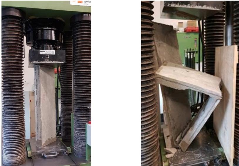
Abbildung 66: Bauteilprüfung zu Beginn (links) und am Ende (rechts)
