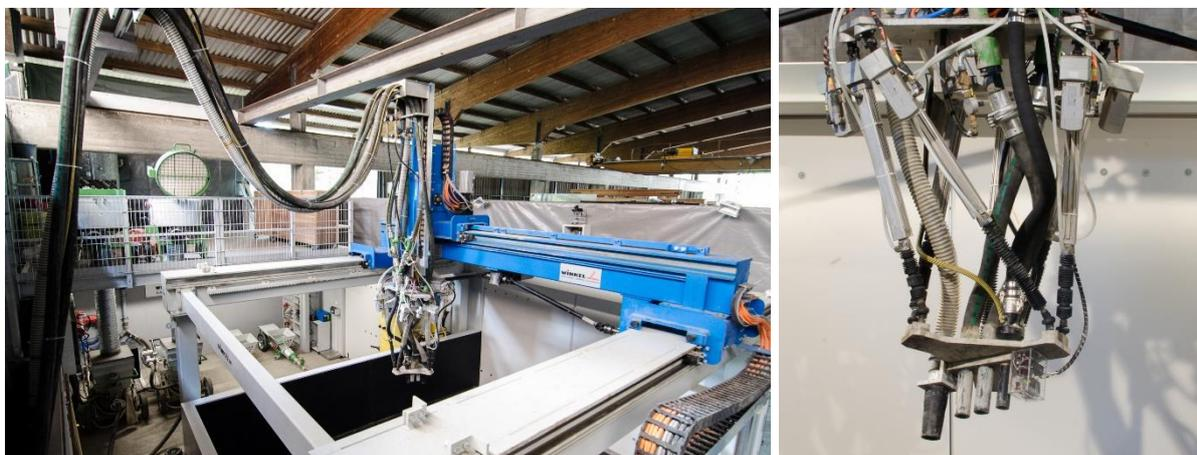
Abbildung 10: Applikationssystem (links) mit Stewart-Gough-Plattform (rechts) [21]
