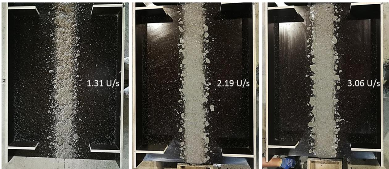
Abbildung 30: Blick von oben auf die Spritzschalung: Spritzbahnen für die drei untersuchten Drehzahlen der Nassspritzmaschine bei 0.8 bar Druckluft und einem Düsenabstand von 0.15 m. Die Spritzbahn wurde von oben nach unten aufgetragen.
