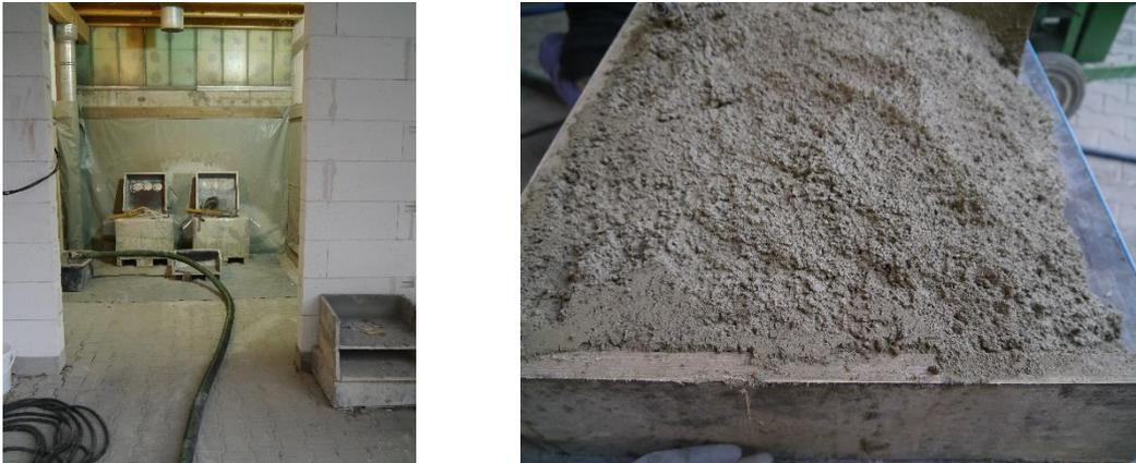
Abbildung 19: Sprühstand im Technikum von HeidelbergCement (links) und Sprühprobe der Mischung  $MII_{NS,HC}(L)$  (rechts)
