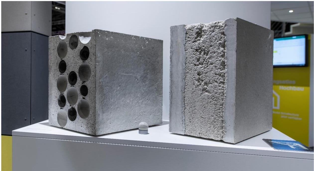
Abbildung 93: Mesogradierter Wandaufbau (links) und mikrogradierter Wandaufbau (rechts) ausgestellt bei der Messe Bau 2019 in München
