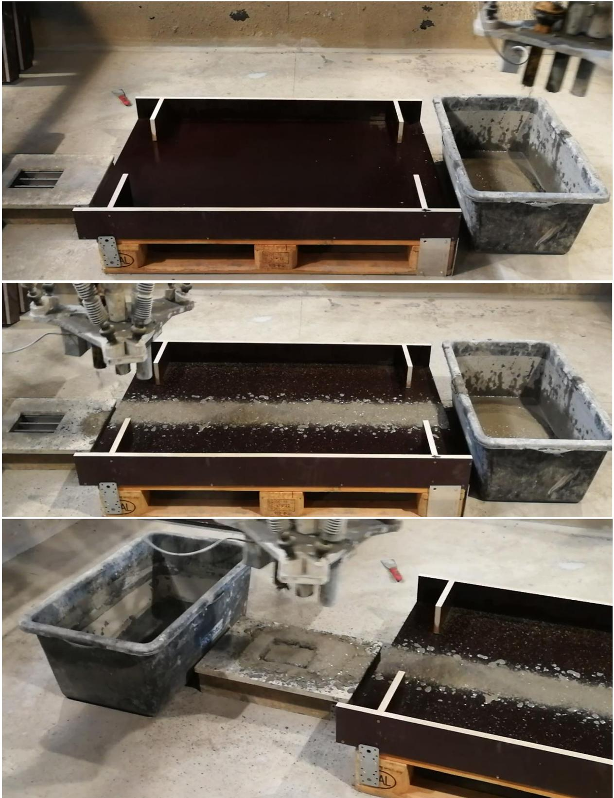
Abbildung 29: Genereller Aufbau (oben) des Versuchsablaufs zur Analyse der Einflussfaktoren des Nassspritzverfahrens für die Mischung M<sub>INS</sub>(IWB)-3.1. Zunächst wird eine charakteristische Bahn für die aktuelle Prozesskonfiguration von rechts nach links appliziert (mittig). Anschließend werden Probekörper nach DIN EN 196-1 hergestellt (unten).
