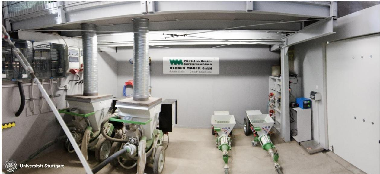
Abbildung 9: Rotortrockenspritzmaschinen (links) und Nassspritzmaschinen (rechts) [21]
