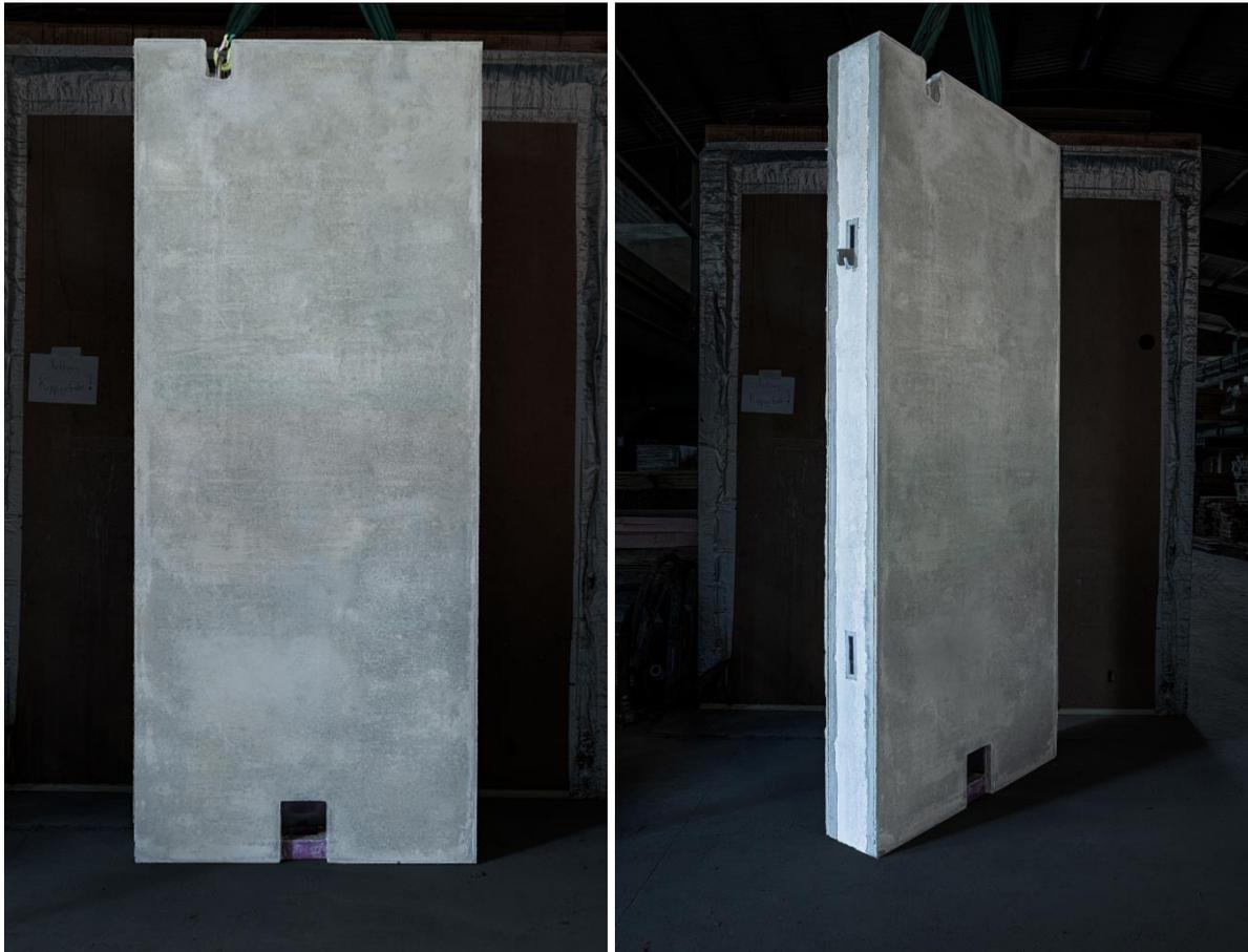
Abbildung 96: Ansicht (links) und Isometrie (rechts) des Funktionsmusters einer mikrogradierten Sandwichwand
