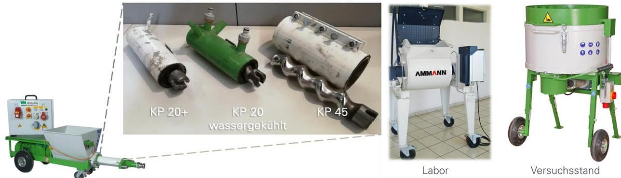
Abbildung 25: Förderereinheit WM Variojet FU der Firma Werner Mader GmbH (links) mit unterschiedlichen Schnecken inklusive Schneckenmantel, Labor-Zwangsmischer CEM 60 S ELBA (mittig) und Zwangsmischer WM Jetmix 125 (rechts)
