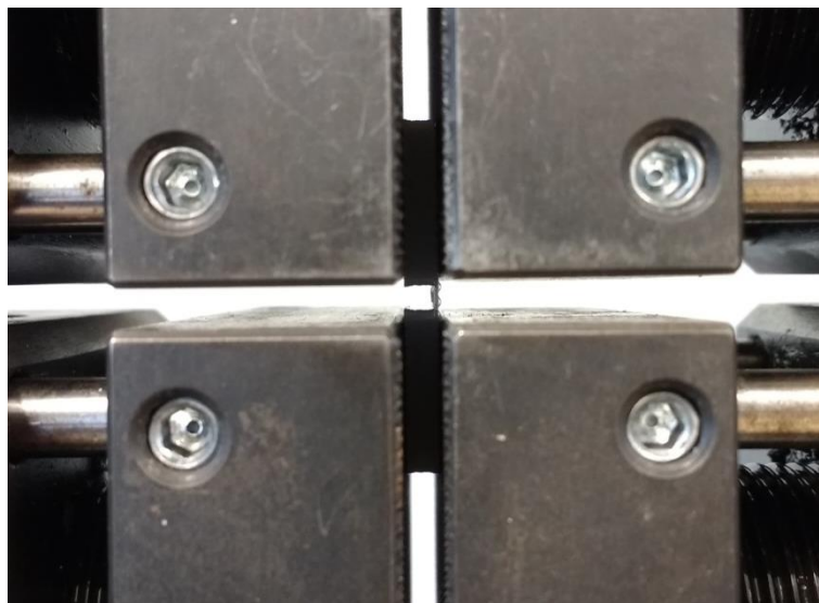
Abbildung 76: Filmgelenkprobe eingespannt zwischen den Spannbacken der Zugprüfmaschine
