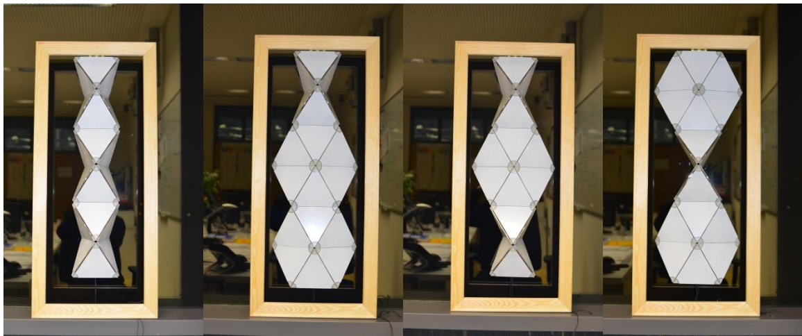
Abbildung 135: Demonstrator für ein adaptives Faltwerk aus Plexiglasplatten mit drei in Reihe angeordneten sechsteiligen Faltelementen, die unabhängig voneinander einzeln gefaltet werden können. Im maximal gefalteten Zustand beträgt die verschattete Fläche nur 25% der Fläche im aufgeklappten Zustand.
