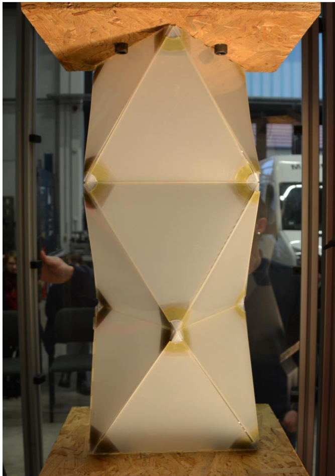
Abbildung 139: Foto während des Druckversuchs an der Faltstruktur mit faserverstärkten 3D-gedruckten Gelenkknoten (Knoten 13).
