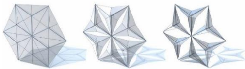
Abbildung 7: Adaptive Sonnenschutzfassade – Al Bahr Tower, Abu Dhabi [ALBA]
