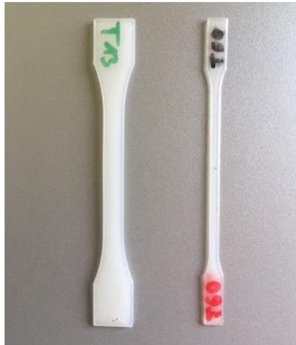
Abbildung 145: Foto der Probengeometrie für Zeitstand-Zugversuch nach Norm DIN EN ISO 527-1 (links) und der verwendeten Probengeometrie mit halbierten Querschnitts-abmessungen. Der Nennquerschnitt wurde von 40 mm 2 auf 10 mm 2 verringert.
