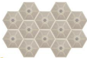
Abbildung 132: Demonstrator für formveränderliche Fassadenverkleidung mit Wabenstruktur, Kombination verschiedener Materialien mit dem 3D-gedruckten Gelenkpunkt. Änderung der Flächenabdeckung von 100% bis 25%
