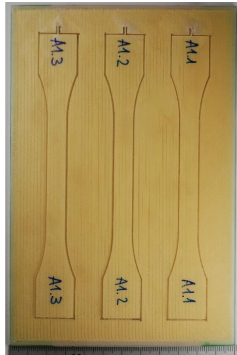
Abbildung 36: additiv hergestellte Platte für Zugproben mit Aramidfaserverstärkung
