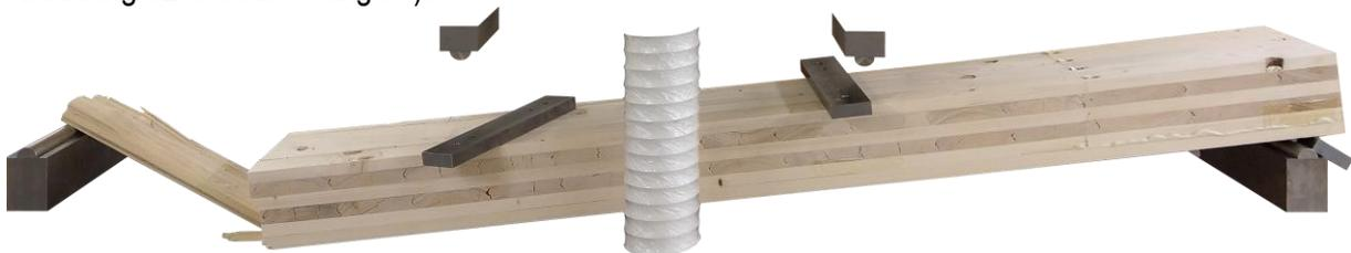
Abbildung 81: Bruchbild 4-Punkt-Biegeversuch an BSP-Restholzträger mit aufgeklebter Zugzone: Zugversagen
