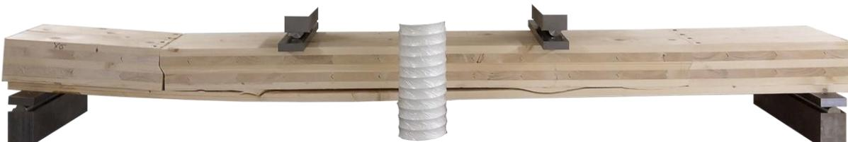
Abbildung 78: Versagen der Klebfuge bei Prüfkörpern mit aufgeklebter Zugzone
