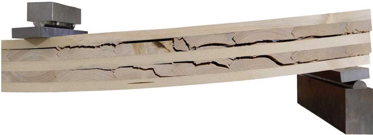
Abbildung 74: 4-Punkt-Biegeversuch an Original-BSP 106W-5 – Rollschubversagen
