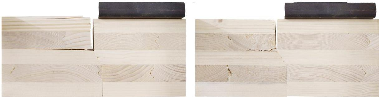
Abbildung 35: Verformungen und Bruchbilder bei nicht verstärktem Querkraftstoß (Versuchsreihe 1)
