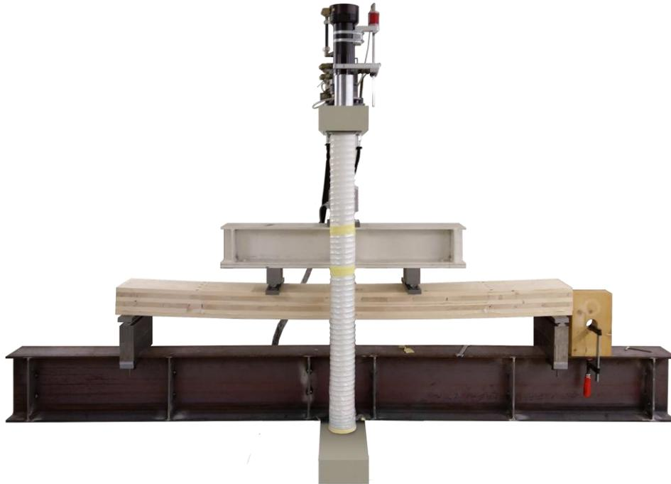
Abbildung 72: 4-Punkt-Biegeversuch – Versuchsaufbau
