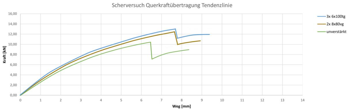
Abbildung 33: Übersicht Scherversuche. Laststeigerung bei querzugverstärkten Querschnitten. Tendenzielle Last-Verformungskurven jeweils aus den 10 Versuchen. Blaue Kurve: Versuchsreihe 3 (Abbildung 37), Braune Kurve: Versuchsreihe 2 (Abbildung 36), Grüne Kurve: Versuchsreihe 1 (Abbildung 35)
