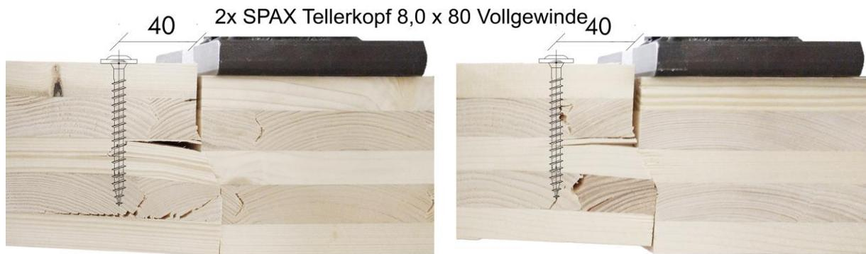
Abbildung 36: Verformungen und Bruchbilder von 2 Versuchen mit verstärktem Querkraftstoß (Versuchsreihe 2): Vollgewindeschrauben 2 x 8x80 vg
