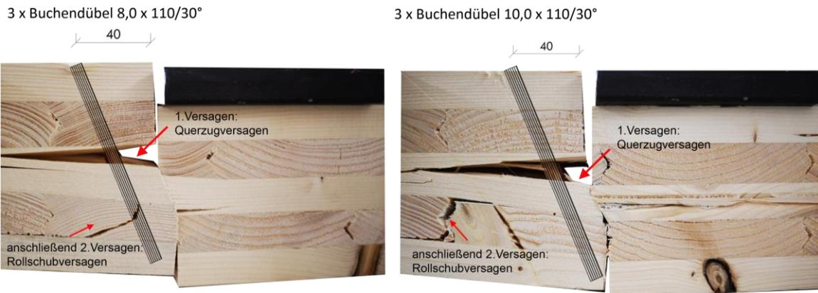
Abbildung 48: Verformung und Bruchbild mit verstärktem Querkraftstoß: links: Variante 6, Buchendübel  $3 \times 8 \times 110 / 30^\circ$ , rechts: Variante 7, Buchendübel  $3 \times 10 \times 110 / 30^\circ$
