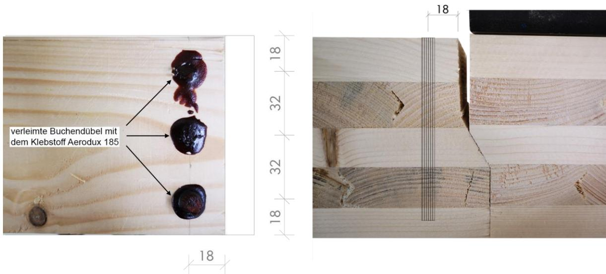
Abbildung 41: Verstärkter Querkraftstoß: Buchenholzdübel 3x8x110 / vertikale Anordnung verklebt
