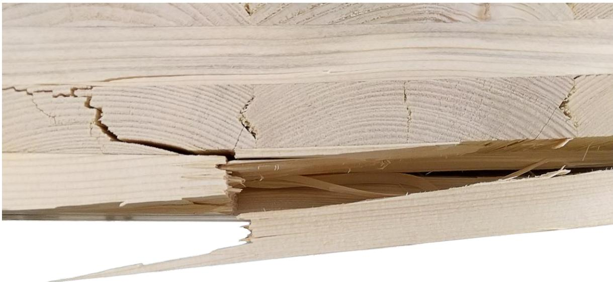
Abbildung 75: 4-Punkt-Biegeversuch an Original-BSP 106W-5 – Zugversagen im Bereich der Keilzinkenverbindung
