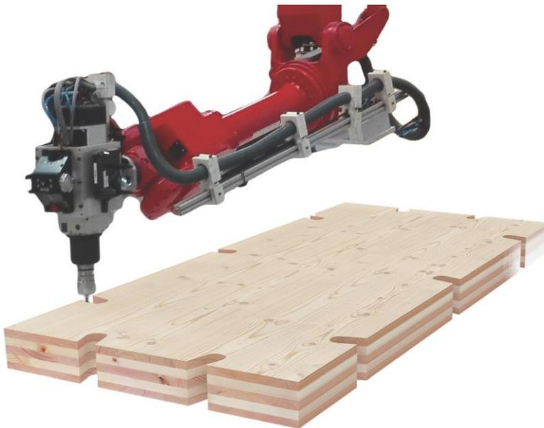
Abbildung 19: Bearbeitung mit Roboterarm (alternativ)
