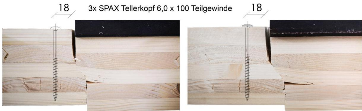
Abbildung 37: Verformungen und Bruchbilder von 2 Versuchen mit verstärktem Querkraftstoß (Versuchsreihe 3): Tellerkopfschrauben 3 x 6x100 tg
