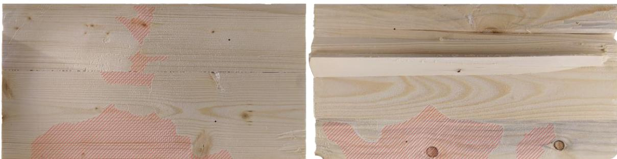
Abbildung 80: Keine vollflächige Verklebung des BSP-Elementes mit der Brettlage. 17,9%(links) und 15,2%(rechts) der Fläche sind nicht verklebt
