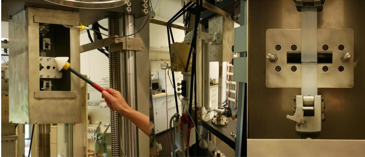
Abbildung 11: Aufbau Mikrowellenzugversuch
