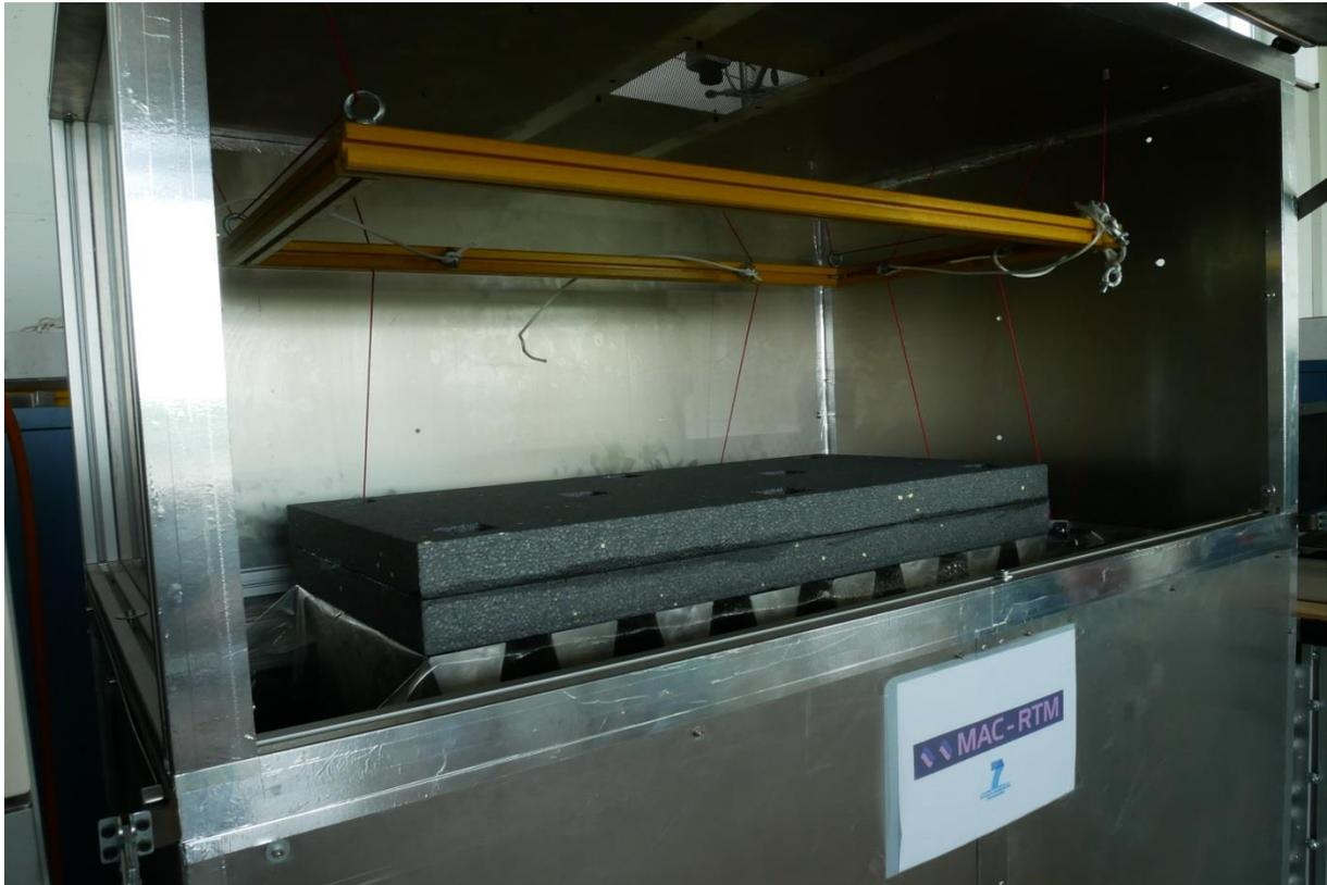
Abbildung 12: MW-Array mit verklebten EPS-Platten
