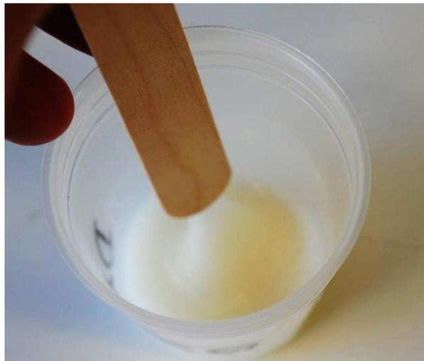
Abbildung 26: 2K-PU-Klebstoff mit 5 Gew. % Benzensulfonyl hydrazid (BSH) nach 14 Tagen Aushärtezeit
