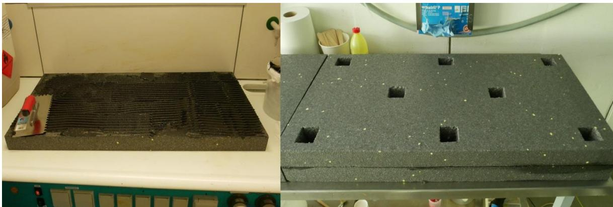
Abbildung 60: Plattenherstellung 1 x 0,5 m für den Entklebeversuch im MAC-RTM
