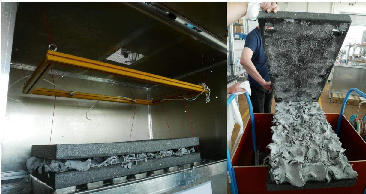
Abbildung 62: Entklebte EPS-Platte nach Mikrowellenbestrahlung im MAC-RTM bei einer Oberflächentemperatur des Klebstoffes von 80 °C
