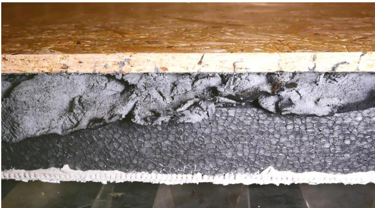
Abbildung 63: WDVS auf OSB nach thermischer Aktivierung des Klebstoffes
