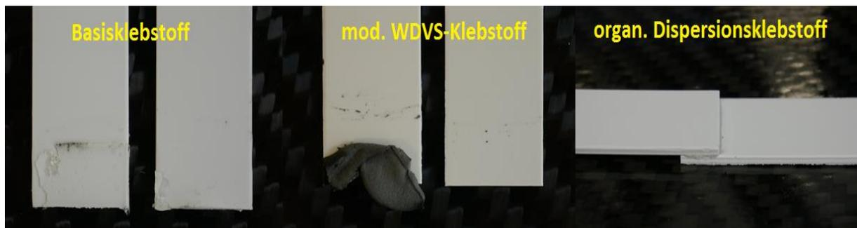
Abbildung 58: Bruchbilder auf Polystyrol nach dem Mikrowellenzugversuch bei 500 W und 10 N Zugkraft
