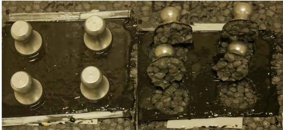
Abbildung 53: Stirnabzugsprüfung vor und nach der Messung, modifizierter WDVS-Klebstoff auf EPS bei 2 mm Prüfschichtdicke
