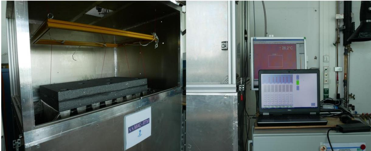
Abbildung 61: Temperaturüberwachung für den WDVS-Klebstoff unter Mikrowellenbestrahlung mittels IR-Kamera
