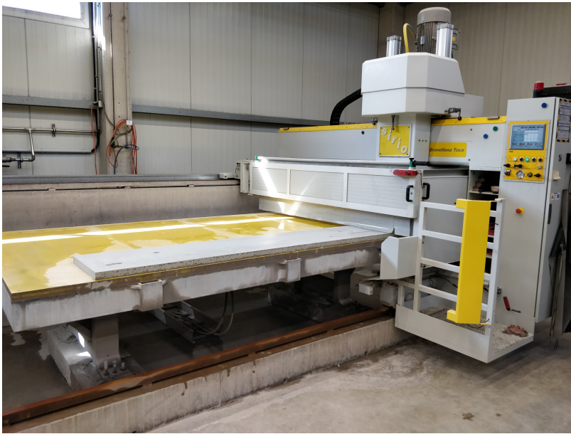
Abbildung 6.4: Betonplatte auf Flächenschleifmaschine
