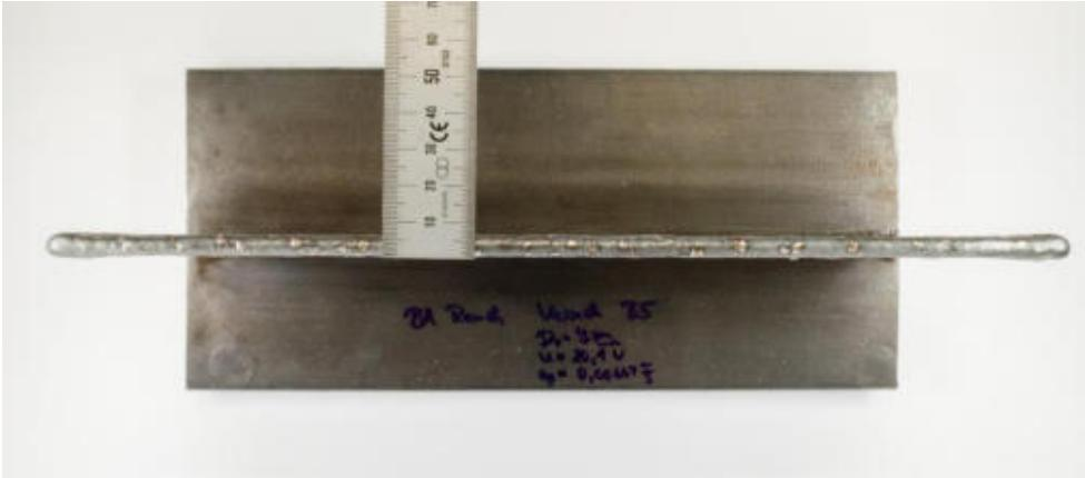
Anhang 3: Bilder Wandstruktur 6 kJ/cm Streckenenergie einreihig ( $T_z = 100^\circ\text{C}$ ) G4Si1
