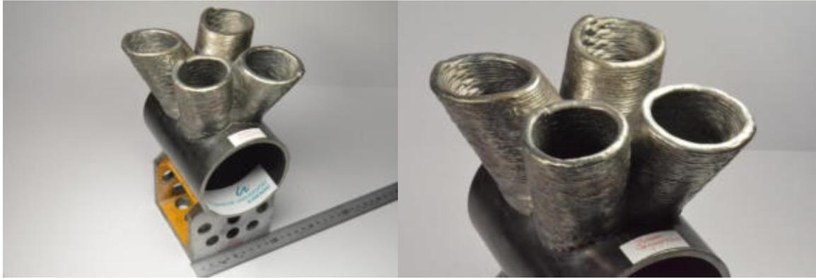
Abbildung 71: additiv hergestellte Knotengeometrie aus gegeneinander verschnittenen Rohren
