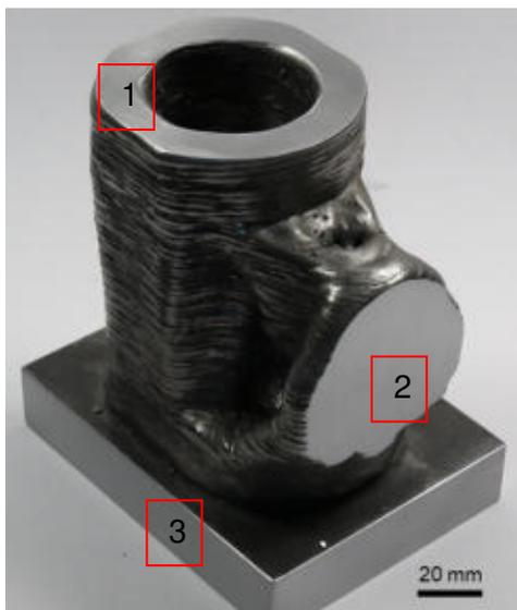
Abbildung 94: additiv gefertigtes, topologieoptimiertes Bauteil mit bearbeiteten Anschlussflächen
