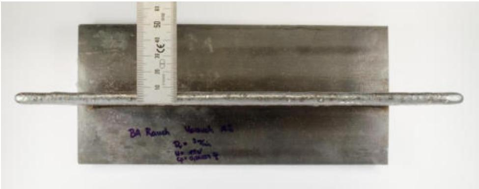
Anhang 4: Bilder Wandstruktur 6 kJ/cm Streckenenergie einreihig ( $T_z = 200^\circ\text{C}$ ) G4Si1
