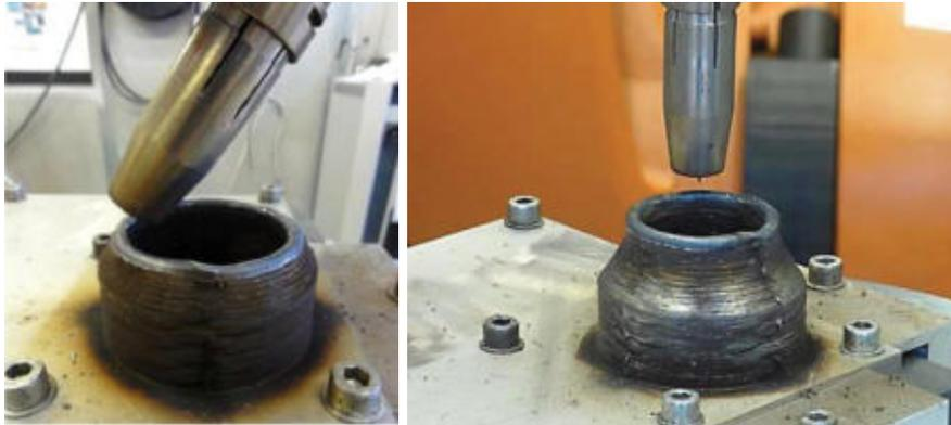
Abbildung 8: additive Herstellung einer Rohrverjüngung mittels MSG-Prozess (G25 20 Mn) [HAR14a]
