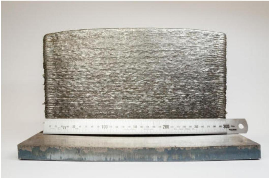
Abbildung 15: Beispiel einer additiv hergestellten Wandstruktur
