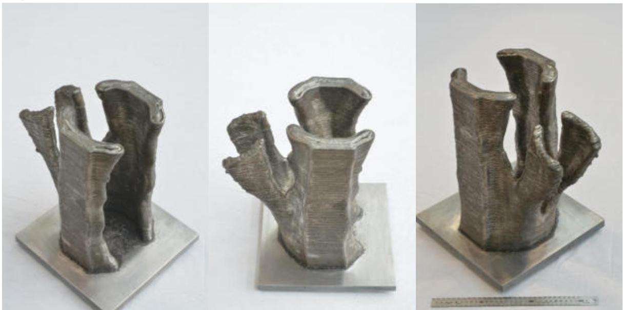
Abbildung 97: additiv gefertigter, topologieoptimierter 30° Schrägstoß
