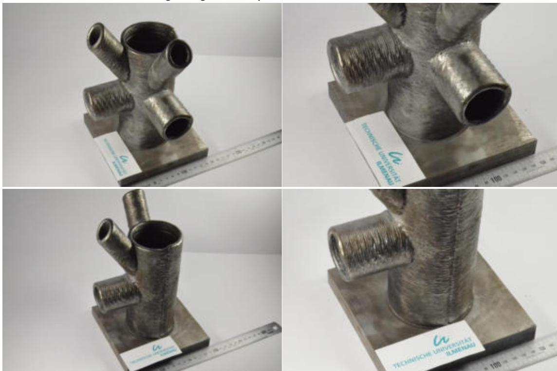
Abbildung 70: additiv hergestellter Obergurtnoten mit Vertikal- und Diagonalstäben
