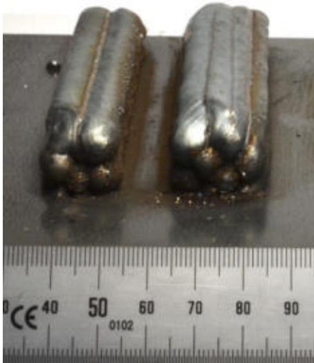
Abbildung 14: Schweißreihenfolge bei mehrreihigem Aufbau (links: Mitte – Außen – Außen; rechts: Außen – Mitte – Außen)
