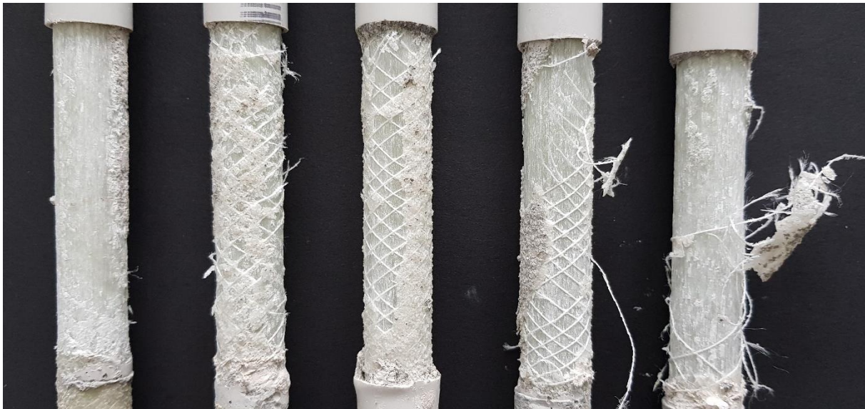
Abb. 7.5: Zeitabhängige Zersetzung der Oberflächenprofilierung von GFK2 bei 60°C. Von links nach rechts abnehmende Auslastung mit zunehmender Standzeit.
