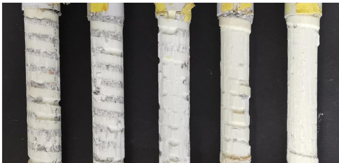
Abb. 7.4: Zeitabhängige Zersetzung der Oberflächenprofilierung von GFK1 bei 60°C. Von links nach rechts abnehmende Auslastung mit zunehmender Standzeit.
