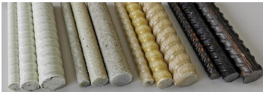
Abb. 5.1: Ansicht der verschiedenen Bewehrungsstäbe mit den Nenndurchmessern 8, 12 und 16 mm. Von links nach rechts: GFK1, GFK2, GFK3 und Stahl1.
