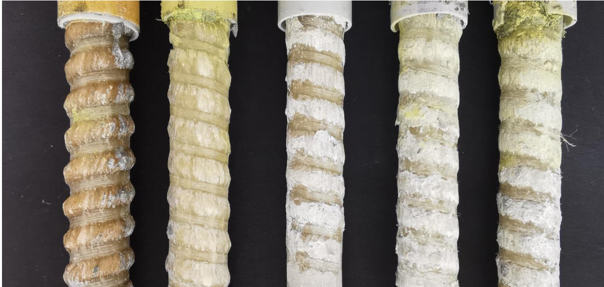
Abb. 7.6: Zeitabhängige Zersetzung der Oberflächenprofilierung von GFK3 bei 60°C. Von links nach rechts abnehmende Auslastung mit zunehmender Standzeit.
