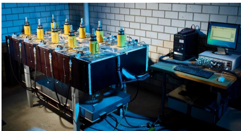
Abb. 7.3: Versuchstand zur Untersuchung des zeitabhängigen Verbundkriechens
