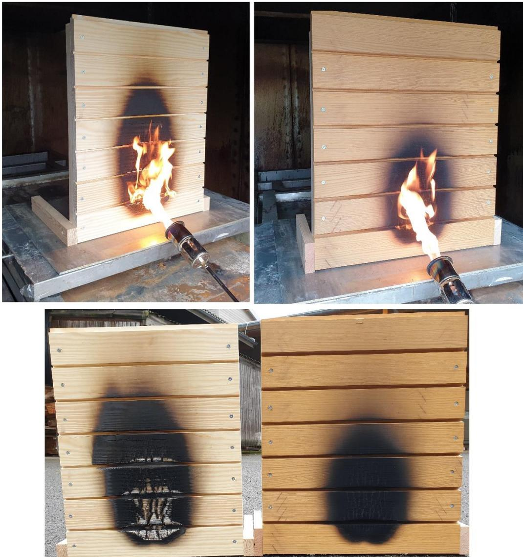
Abbildung 25: Flächenbeflammung einer gebauten Holzverkleidung. Links unbehandelte Kiefer; rechts mit J imprägniert.
