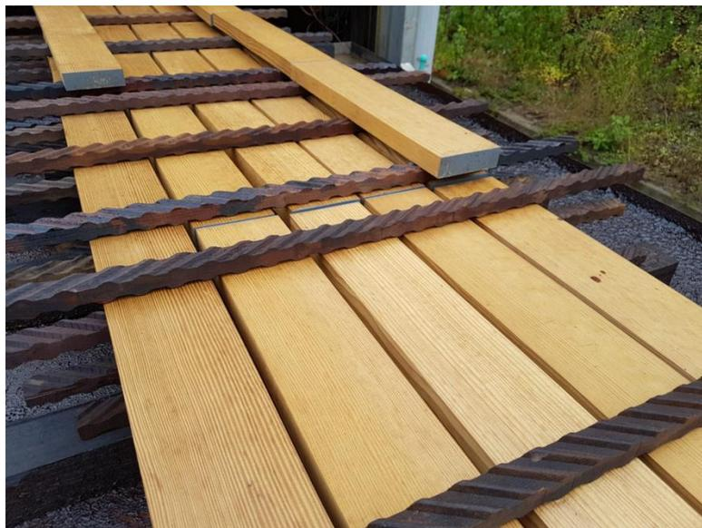
*Abbildung 23:* Symbolbild der bereits imprägnierten Bretter mit 1 m und 0,5 m Länge. Deutlich zu erkennen sind die versiegelten Kanten, um ein Eindringen der Lösung in axialer Richtung zu unterbinden.
