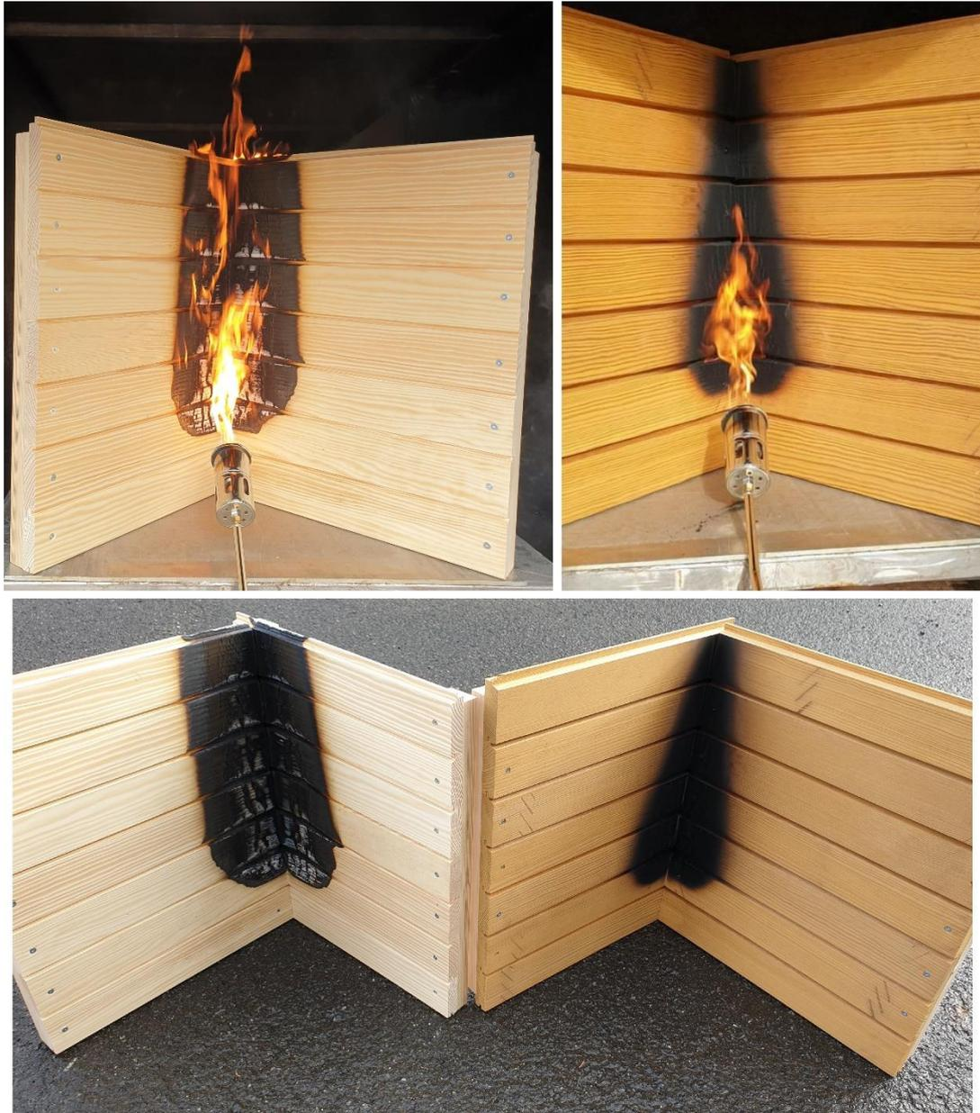
Abbildung 26: Eckbeflammung einer gebauten Holzverkleidung. Links unbehandelte Kiefer; rechts mit J imprägniert.
