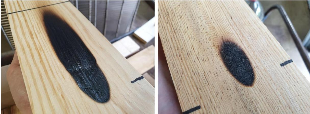
Abbildung 8: Exemplarische Fotos von Kleinbrennkasten Messungen nach DIN EN ISO 11925-2. Links unbehandelte Referenz, Rechts mit Flammschutzmittel C behandelt.
