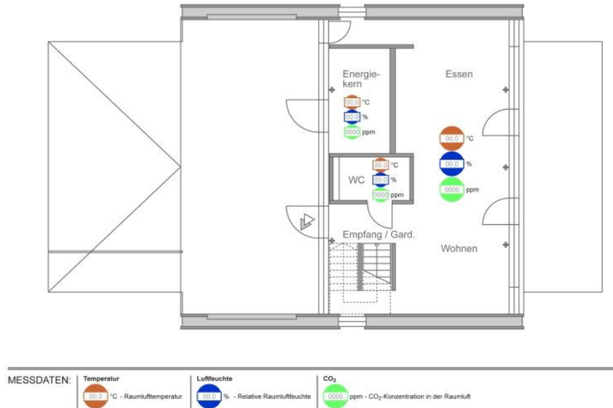
Bild 5: Messparameter Innenraumklima Erdgeschoss.
