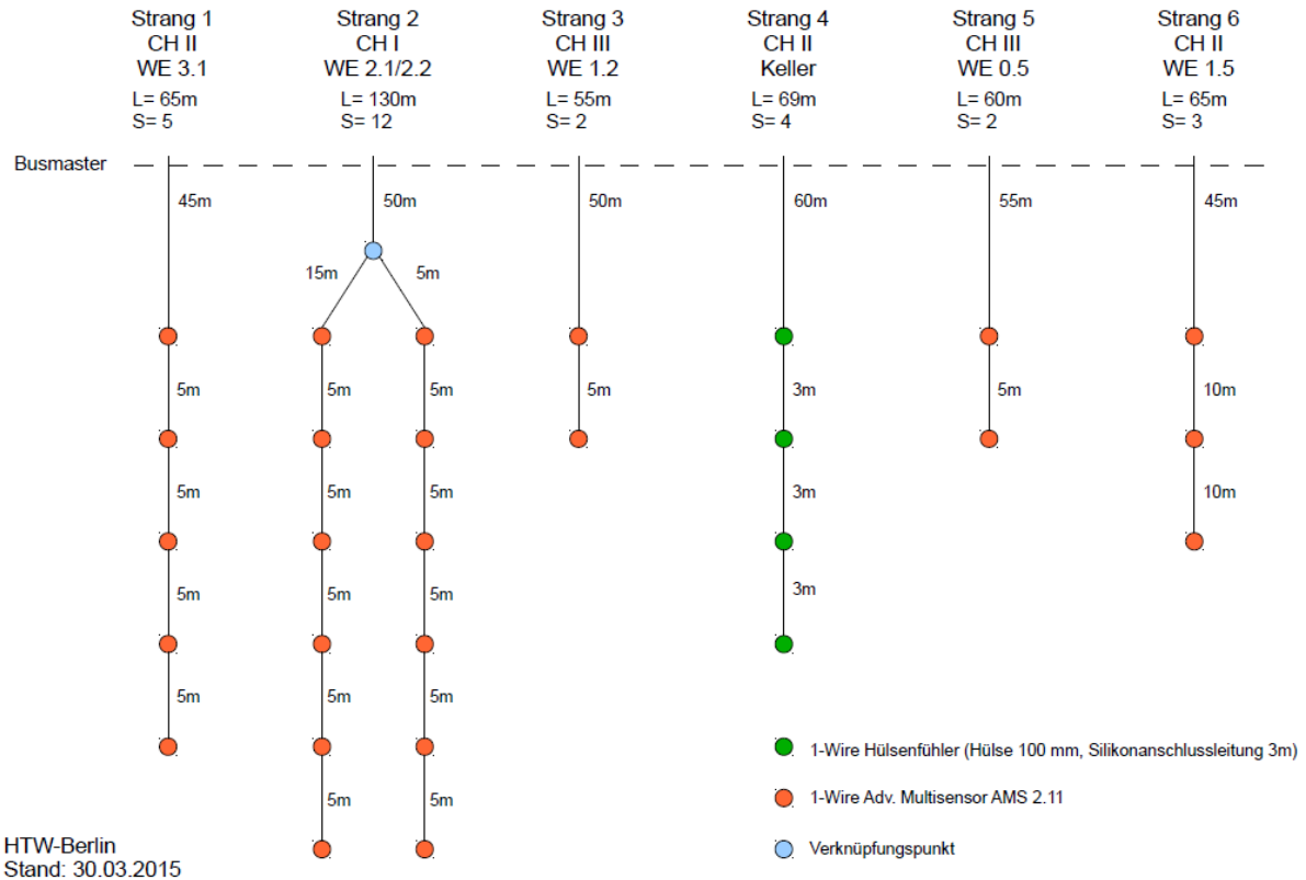
Abbildung 61: Strangschemata für das 1-Wire-Netzwerk im LVV-Gebäude.
